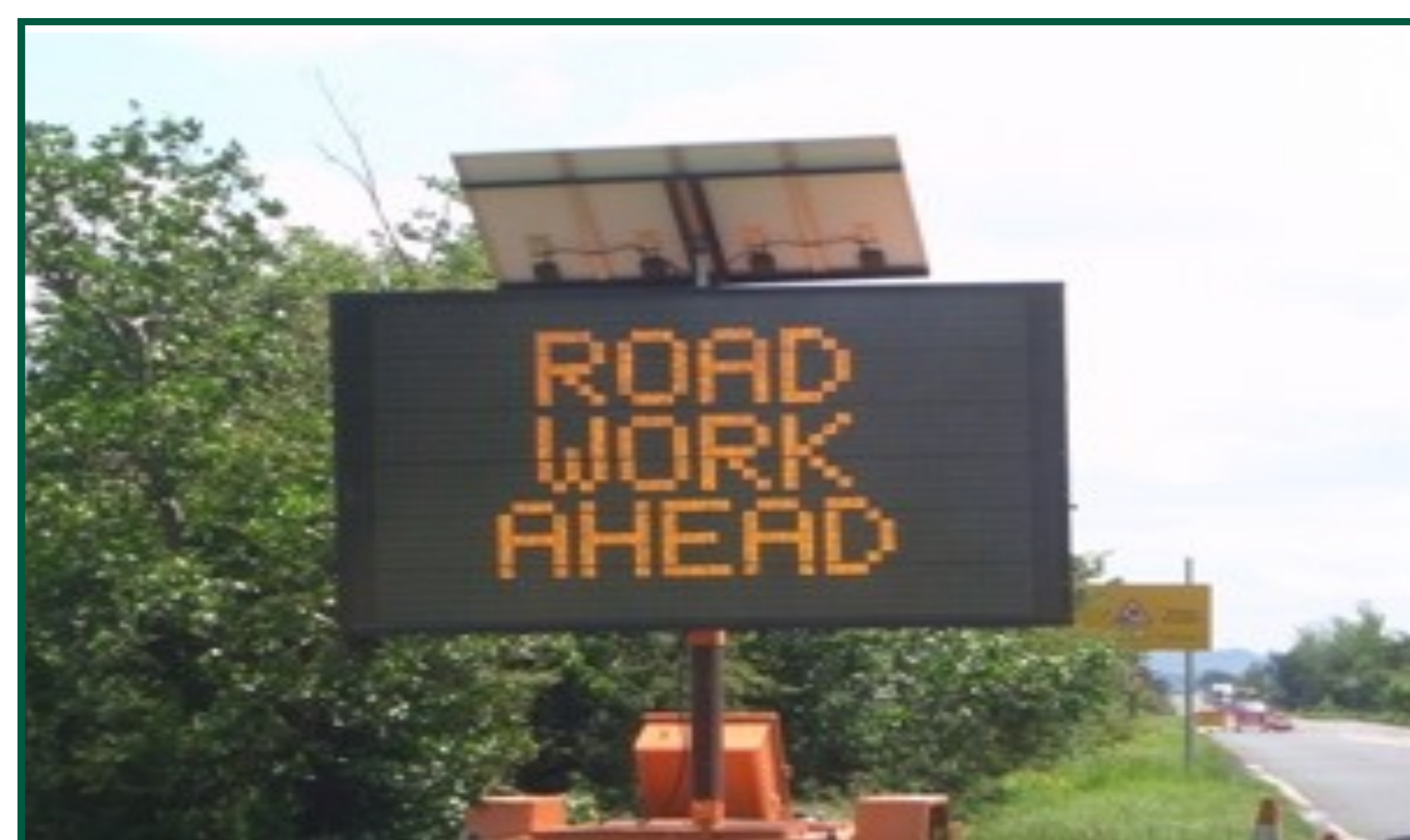
Figure 3a. Signalisation avancée grâce à des panneaux à messages variables portables.
